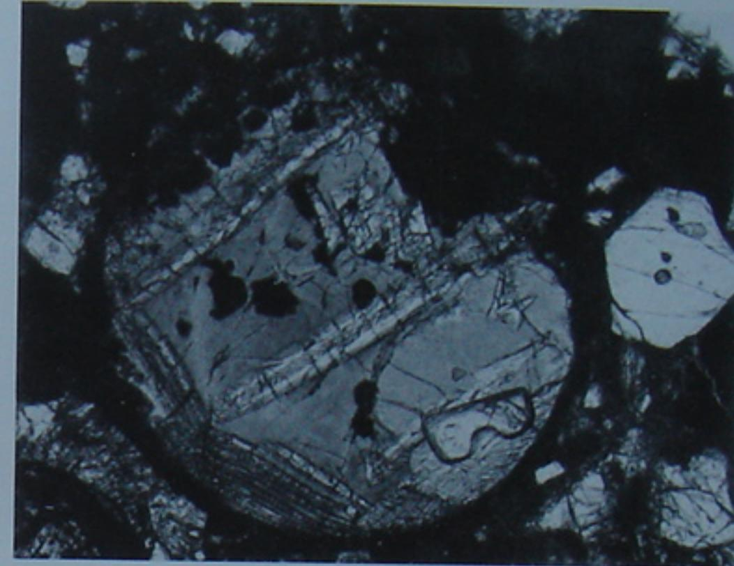
Abb. 4. Chondre Tie XII. Maximaler Durchmesser: 0,68 mm. Durchlicht. Rötliches Glas mit langgestreckten, einschlüssereichen Olivinen, Balkenoliven und Sulfid-Nestern. Rechts unten ein großer korrodiertes Spinell in hellgrauer anorthitreicher Matrix
