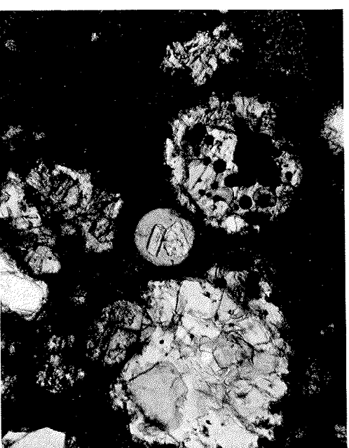
Abb. 6. Kleine Ca-Al-reiche Chondre (Zentrum, Lancé 1/31) bestehend aus Glas und 2 Hibonitkristallen (siehe Tab. 4 und Abb. 7). Daneben links ein typisches metallreiches und rechts ein metallarmes Fragment. Durchlicht. Bildlänge: 0,38 mm.
