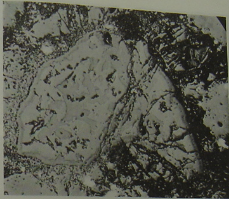
Abb. 1. Lancé 1/5; Verwachsung von Melilith (grau) mit Spinell (hellgrau) eingesäumt von nephelinreicher Zone (grau) und diopsidischem Pyroxen (hellgrau). Auflicht, Bildlänge ca. 0.3 mm.
